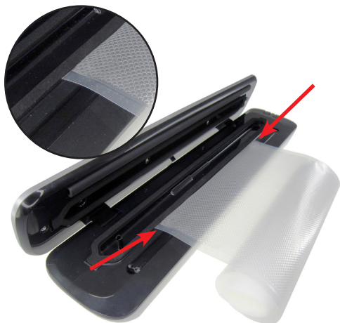
Slika 2: Pri varjenju mora biti vrečka na varilnem traku - do črnega tesnila kot prikazujeta puščici (in ne čez).
