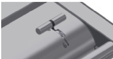
Slika 8: Med ročnim vakuumiranjem mora biti ročka v zaklenjenem položaju.
