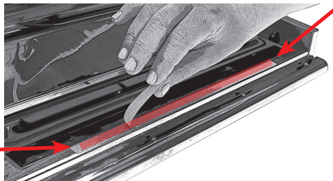
Slika 3: Pred namestitvijo obojestranskega lepilnega traku nujno očistite površino aparata.
