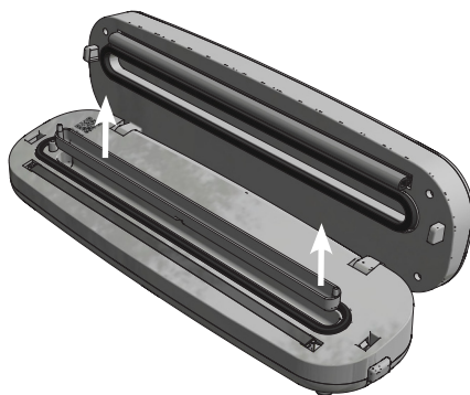
Slika 5: Ako tekućina uđe u vakuumske kanal, podignite posudicu ravno prema gore, izlijte tekućinu te dobro osušite posudicu.
