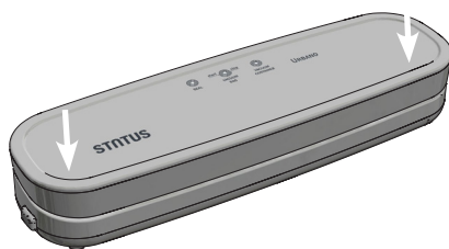
Slika 2: Zaklepanje pokrova s pritiskom na levi in desni rob.
